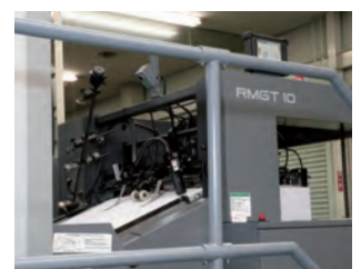
一本ベルト式給紙部 (跳ね上げ方式のハケコロ・ゴムコロ装置も装備)
