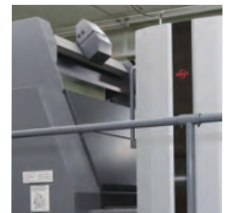
排紙部の上に設置されたCCDカメラが品質保証を支える
